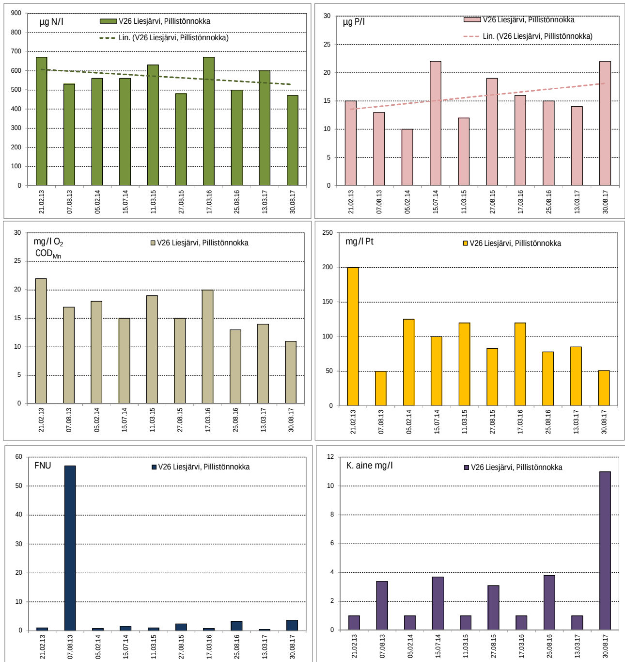
Kuva 5.19. Rinnansuon alapuolisen Liesjärven veden (1 m) typpi-, fosfori-, \text{COD}_{\text{Mn}} - ja kiintoainepitoisuudet vuosina 2011–2017.
