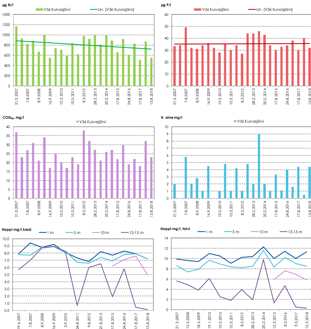
Kuva 5.65. Kuivasjärven vedenlaadun sekä happitalouden kehitys (1 m) vuosina 2007 - 2018.
