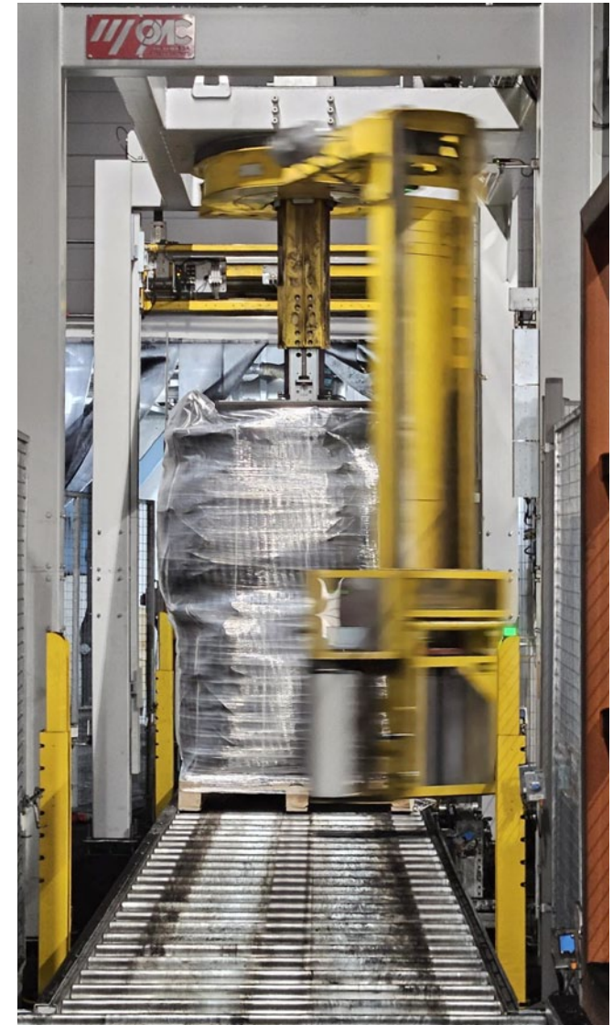
Automaattinen käärintälaite toiminnassa Novactorin Ilomantsin aktiivihiilitehtaassa.
