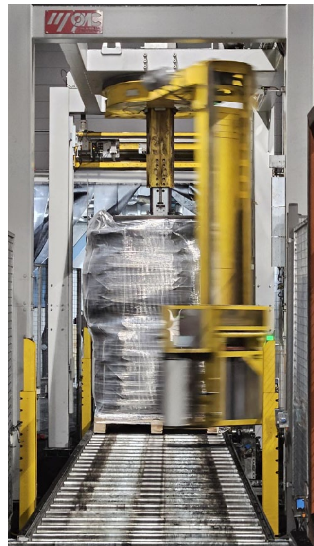
Automaattinen käärintälaite toiminnassa Novactorin Ilomantsin aktiivihiilitehtaassa.
